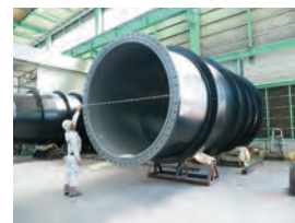
水道用塗覆装鋼管（異形管） (国内シェア1位)
