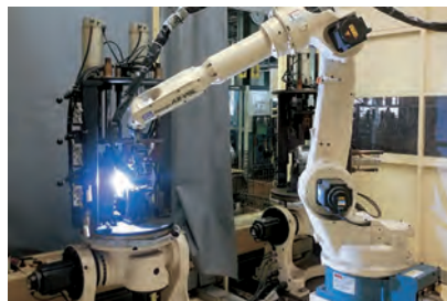
ロボット溶接機
