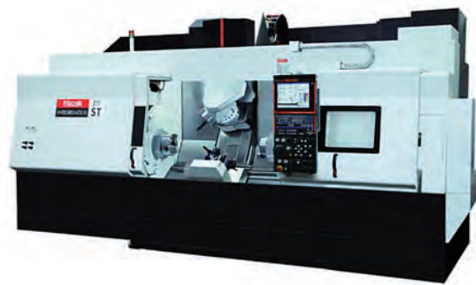
複合加工機を改造し6軸複合加工機を開発
