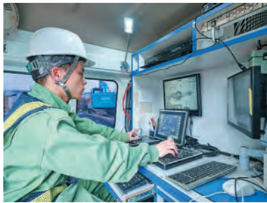
下水道管路調査
