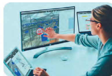
3D/2D統合コミュニケーションツールRevizto (BIM/CIM、点群、PDF図面、現場データを 融合して表現させることができるツール)
