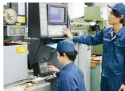
MAX相セラミックスのワイヤ放電加工 (卒業研究・5学年)
