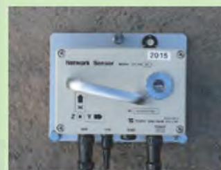
図1 微動計測機器（加速度計内蔵ネットワークセンサ）
