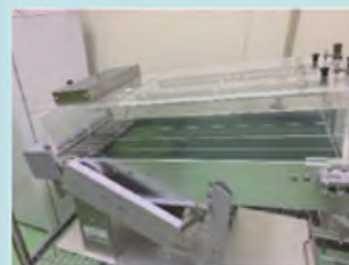
図3. マウス / ラット用トレッドミル装置 (メルクエスト)
