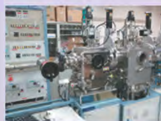
図1 真空蒸着—グローブボックス—貫装置
