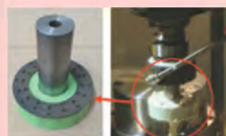
図1 3D プリンタで作製した内部に研削液の流路を持つ砥石
