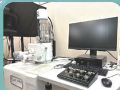
電子顕微鏡 元素分析機能付き IT-2000LA (JEOL) 倍率～1万倍 含有元素の特定、観察
