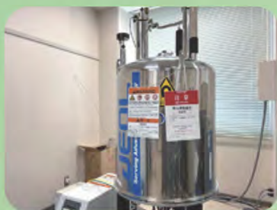
NMR JNM-ECX400II (JEOL) 有機構造を特定
