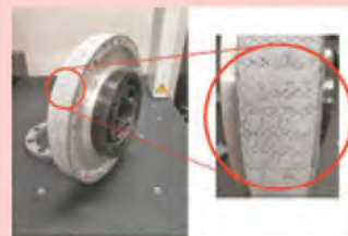
図3 ハニカム形状の切れ刃を有する砥石
