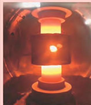
酸化物セラミックスの焼結接合
