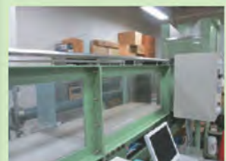
図3 傾斜可変開水路
