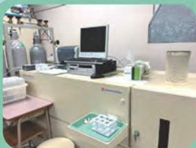
ICP-AES ICPS-7510 (島津製作所) 含有元素の特定、定量
