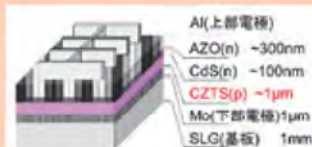
CZTS 薄膜太陽電池の 試作品（上）と構造図（下）
