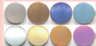
図3 陽極酸化によるMAX相セラミックスのカラーリング
