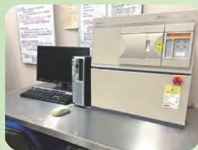
X線回折分析 MiniFlex (RIGAKU) 無機物の結晶構造を解析
