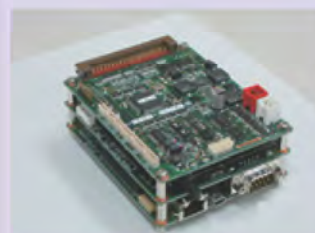
図3 遠隔操作・画像伝送システム
