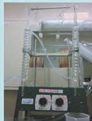
図2 分析蒸留機（清酒のアルコール度を測定する前処理に使用）
