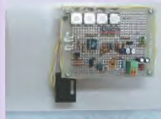
図2 圧電式自己発電型リモコン
