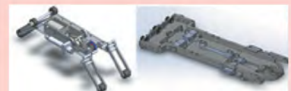
図3 橋梁遊間部の打音点検装置
