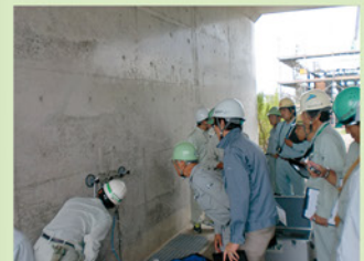
図3 表面吸水試験装置 (SWAT) を用いたコンクリートの品質調査
