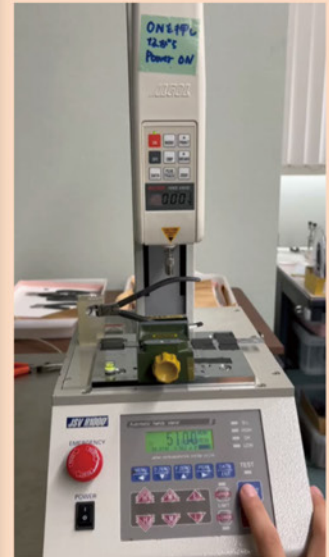
図 3. 簡易荷重試験機を用いたニッパの切れ味測定の様子
