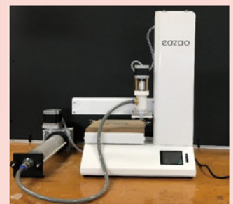
図8 粘土の積層が可能な3Dプリンタ
