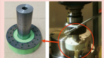
図 2 3D プリンタで作製した内部に研削液の流路を持つ砥石
