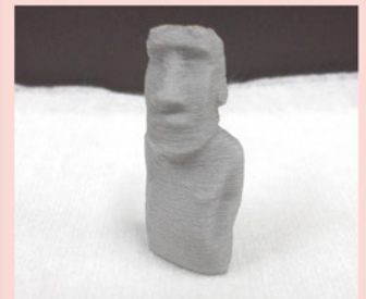
図 1 3D プリンタで作製した総形砥石
