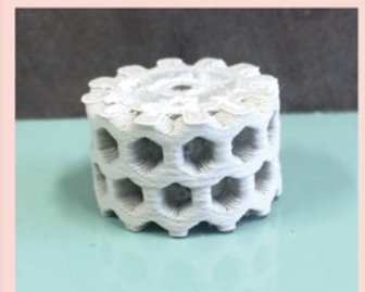
図 3 チップポケットの大きさを制御できる 3D プリンタ製砥石
