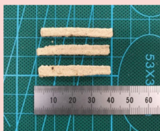
図9 3Dプリンタで作製したホーニング砥石
