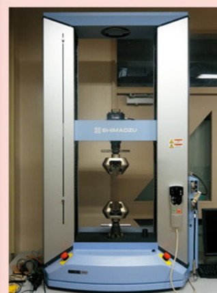
図1 卓上万能材料試験機 (SHIMADZU社)
