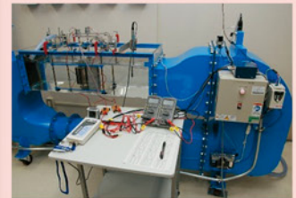
図6 水槽実験による小型水車の実験
