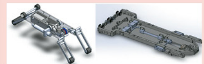
図3 橋梁遊間部の打音点検装置
