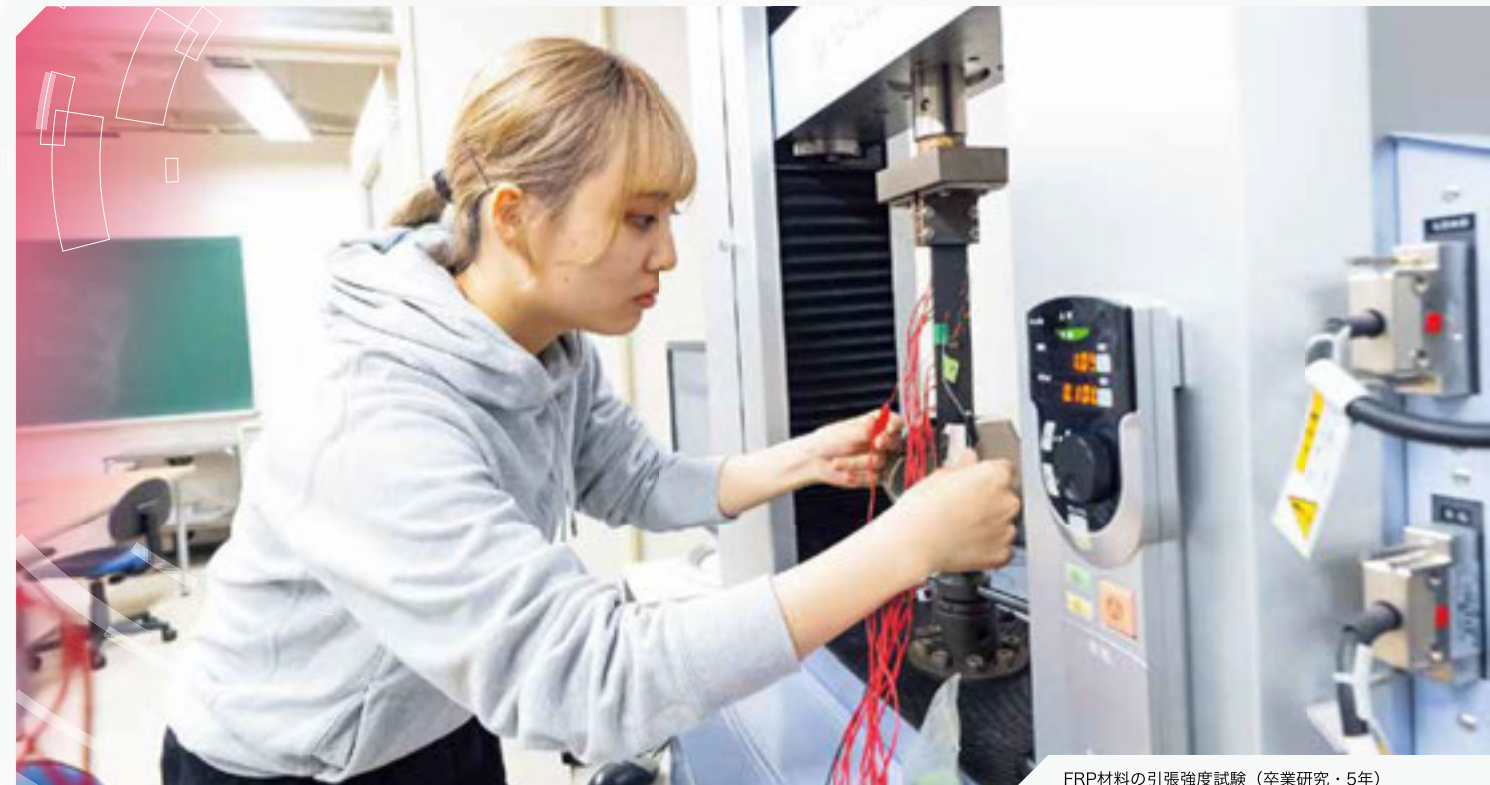
FRP材料の引張強度試験（卒業研究・5年）
