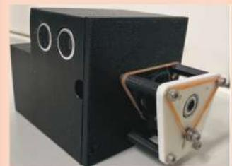
図 3. テグスを用いた鳥害対策装置の試作機
