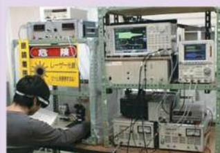
図1 電氣的過渡応答法による測定
