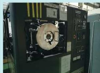
図4 プラズマ放電焼結装置
