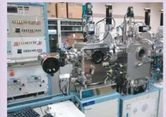
図1 真空蒸着—グローブボックス—貫装置
