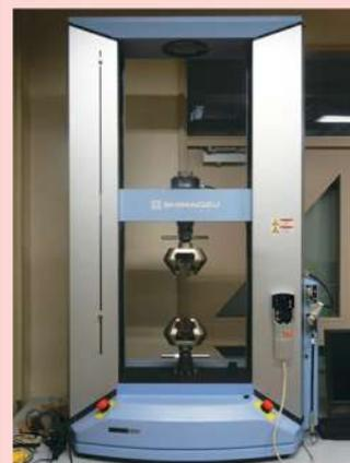
図1 卓上万能材料試験機 (SHIMADZU社)
