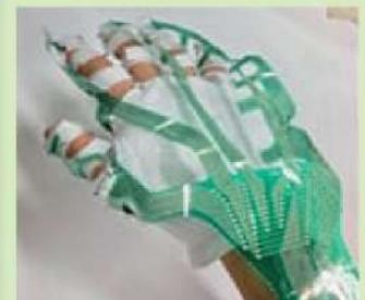
図3 圧力分布測定
