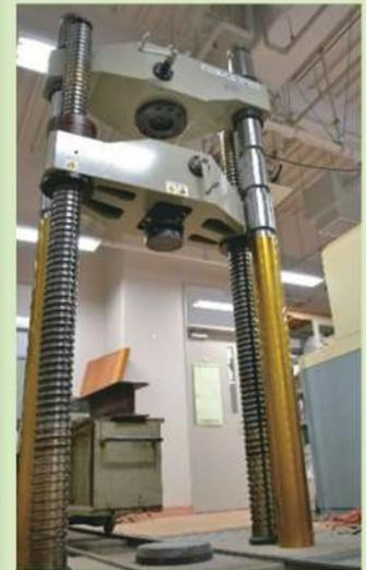
図1 1000kN万能試験機
