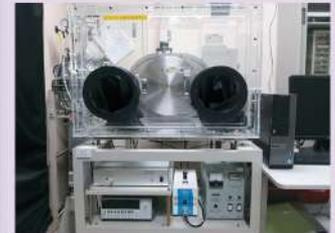
図2 光電子収量分析装置
