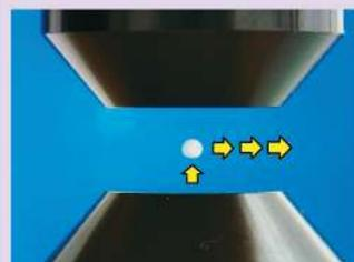
図3 超音波による非接触運搬
