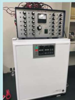
図2 電解結晶化装置
