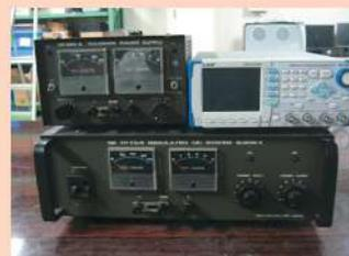
図1 電源および任意波形発生装置
