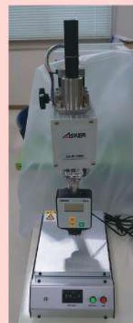
図3 ゴム高度計、定圧荷重装置
