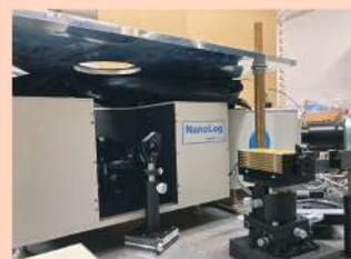
写真3 モジュール型蛍光分光測定装置
