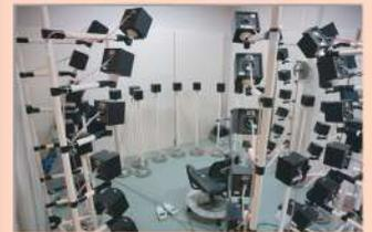
遮音室 / 音像定位システム設備
