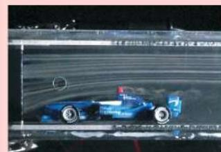
図2 マイクロ風洞による流れの可視化
