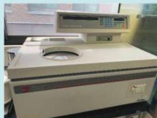
図2. 超遠心分離装置 (ベックマン・コールタージャパン)
