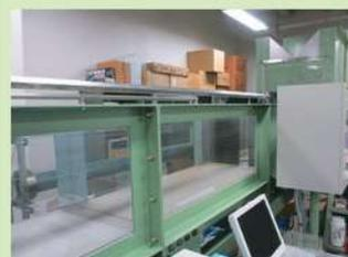
図3 傾斜可変開水路
