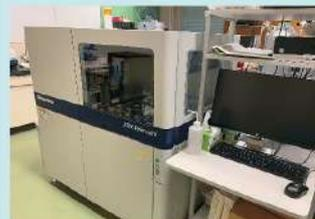
走査型波長分散蛍光 X 線分析装置 (Rigaku ZSX Primus IV) 学科共通機器
