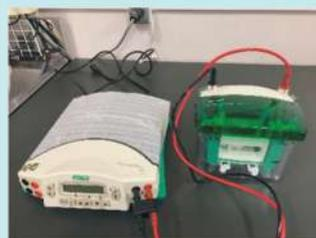
図1. 電気泳動装置 (バイオラッド)
