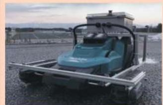
図 2. 遠隔操作型草刈り機の試作機
