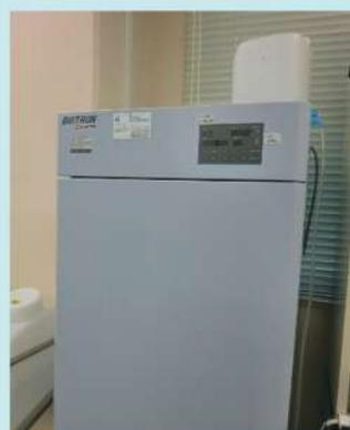
図1 植物環境制御装置人工気象器
