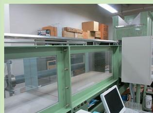
図3 傾斜可変開水路
