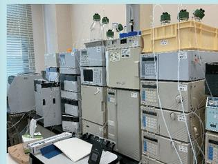
各種高速液体クロマトグラフィーおよび分取 LC システム
