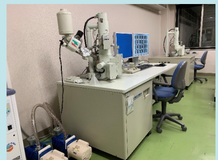
走査型電子顕微鏡 (EDX付SEM:JSM-6360LA, 低温・低真空SEM:JSM-6060LV:JSM-6060LV) 学科共通機器
