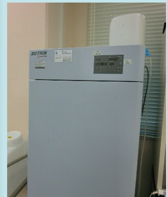
図1 植物環境制御装置人工気象器
