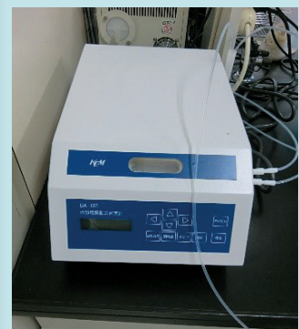
図3 振動式密度計（清酒のアルコール度と日本酒度を測定するために使用）
