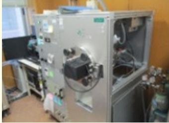
薄膜を成膜する RF スパッタ装置
