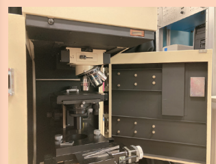
写真2 ダブルレーザーラマン分光測定装置 ※顕微鏡で微小区間の測定向き
