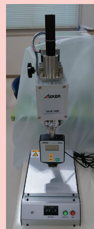
図3 ゴム高度計、定圧荷重装置 (軟質ゴム・ウレタンフォーム・スポンジ・巻き糸・フィルムロール・陶土・フットウェア)
