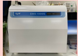
図 4 EMS 粘度計 (電磁スピニング法による粘度測定、 測定範囲 0.1 ~ 100,000mPa・s)
