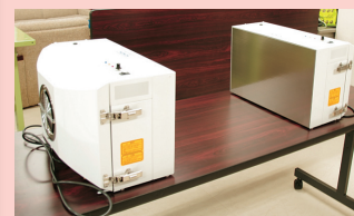
図2 オープンクリーンベンチ (清浄空間: 700 mm、清浄度: ISOクラス1)
