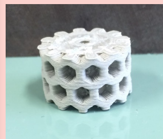
図3 チップポケットの大きさを制御できる3Dプリンタ製砥石
