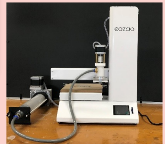
図8 粘土の積層が可能な3Dプリンタ
