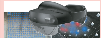
図2 HoloLens2 によるコンクリート壁面への点検位置の重ね合わせ
