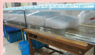
雪冷房の熱交換実験
