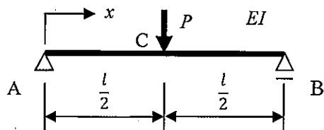
(1) この単純ばかりの A 点からの距離  $x$  の位置での曲げモーメントの式を、AC 間および CB 間についてそれぞれ求めよ。
