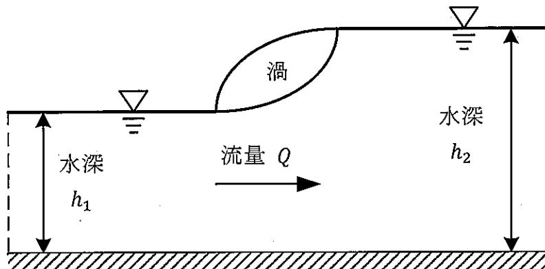
(1) 図の破線及び水面、底面とで囲まれる領域を検査領域（コントロールボリューム）としたとき、この検査領域に作用する全水圧を、与えられた記号を用いて式で表せ。ただし右向きを正とする。
