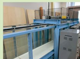
図2 二次元造波水路
