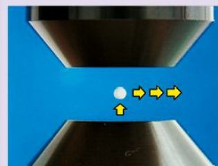
図3 超音波による非接触運搬
