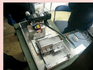
貯雪のせん断強度試験
