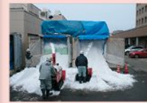
保冷コンテナへの雪入れ作業
