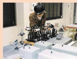
図1 ダブルパルスレーザーによる微細加工
