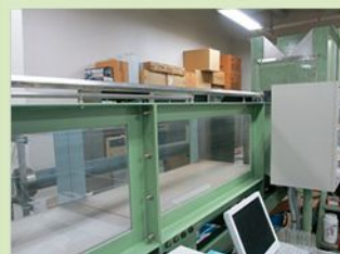
図3 傾斜可変開水路
