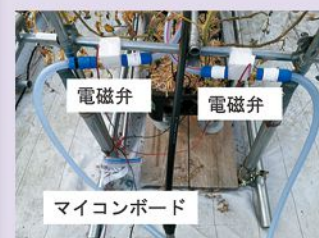
図3 トマト栽培における自動灌水システムの構築に関する研究
