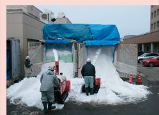
保冷コンテナへの雪入れ作業
