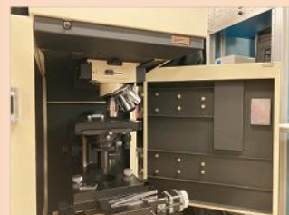
写真2 ダブルレーザーラマン分光測定装置
