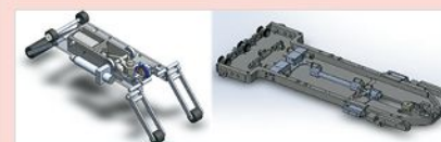
図3 橋梁遊間部の打音点検装置
