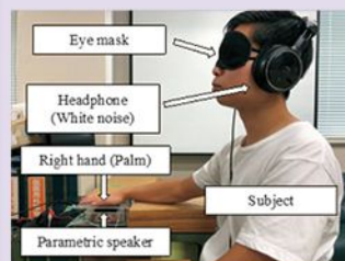
図4 音響放射力を用いた振動感覚感受性の検査
