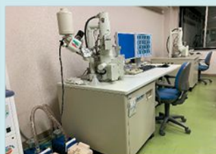
走査型電子顕微鏡（SEM:JSM-6060LV、SEM-EDX:JSM-6360LA）学科共通機器
