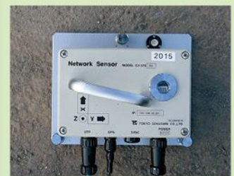
図1 微動計測機器（加速度計内蔵ネットワークセンサ）
