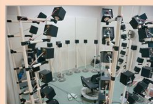
遮音室 / 音像定位システム設備
