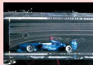
図2 マイクロ風洞による流れの可視化
