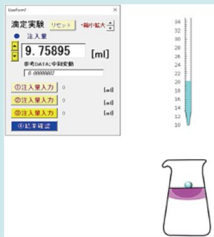
図 リモート学習に対応する PC における中和滴定画面
