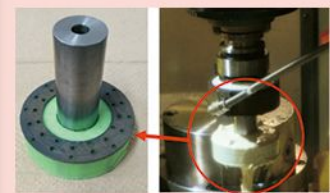
図1 3Dプリンタで作製した内部に研削液の流路を持つ砥石
