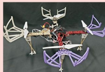
図1 研究用ドローン LAB445 (Raspberry Pi マイコン、LiDAR センサ追加)
