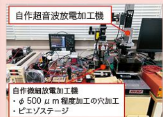
図1 ピエゾステージや超音波振動を用いた放電加工特性向上の試み
