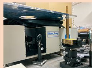
写真3 モジュール型蛍光分光測定装置
