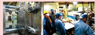
図2 セラミックス製入れ子による環境対応型射出成形金型の開発
