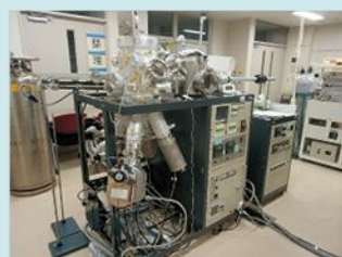
硫黄クラッキングセル付き多元硫化物製膜装置
