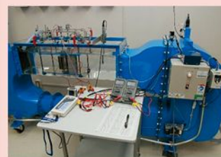
図3 水槽実験による小型水車の実験
