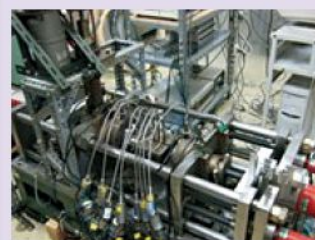
図3 背圧付加型熔融樹脂流動試験機
