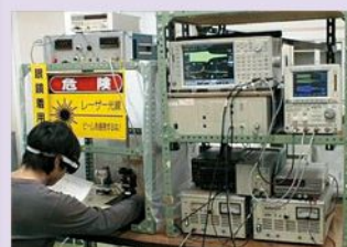
図1 電氣的過渡応答法による測定
