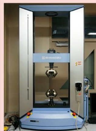
図1 卓上万能材料試験機 (SHIMADZU社)
