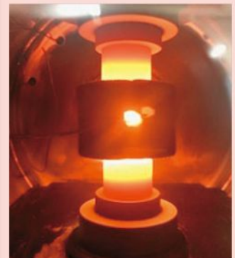
酸化セラミックスの焼結接合
