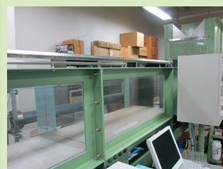
図3 傾斜可変開水路
