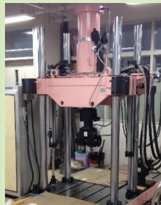
図2 200kN疲労試験機
