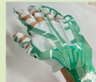
図4 圧力分布測定
