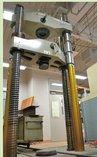
図1 1000kN万能試験機
