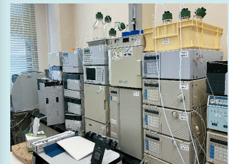
各種高速液体クロマトグラフィーおよび分取 LC システム
