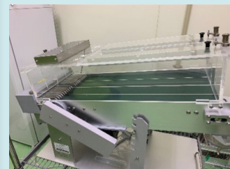
図3. マウス/ラット用トレッドミル装置 (メルクエスト)
