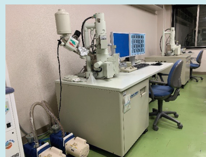
走査型電子顕微鏡 (EDX付 SEM:JSM-6360LA, 低温・低真空 SEM:JSM-6060LV:JSM-6060LV) 学科共通機器
