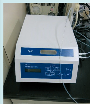
図3 振動式密度計(清酒のアルコール度と日本酒度を測定するために使用)
