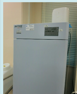
図1 植物環境制御装置人工気象器
