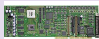
図4 リアルタイム制御装置
