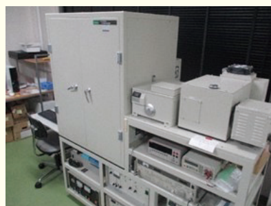
電圧と電流の関係を調べるソーラーシミュ レータ
