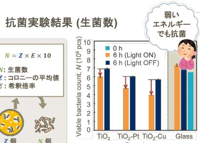
可視光応答型光触媒の抗菌性能評価は日本工業規格 (Japanese Industrial Standards:JIS) による試験方法に従い行っています。
