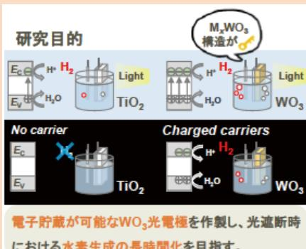
電子貯蔵が可能な  $WO_3$  光電極を作製し、光遮断時における水素生成の長時間化を目指す。
