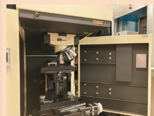
写真2 ダブルレーザーラマン分光測定装置 ※顕微鏡で微小区間の測定向き
