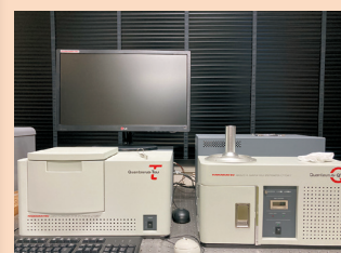
写真1 小型蛍光寿命測定装置および絶対PL量子収率測定装置
