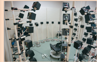
遮音室 / 音像定位システム設備
