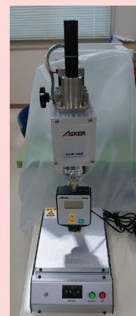
図3 ゴム高度計、定圧荷重装置 (軟質ゴム・ウレタンフォーム・スポンジ・巻き糸・フィルムロール・陶土・フットウェア)
