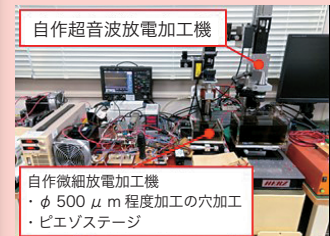
図1 ピエゾステージや超音波振動を用いた放電加工特性向上の試み
