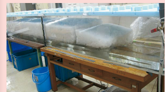
雪冷房の熱交換実験
