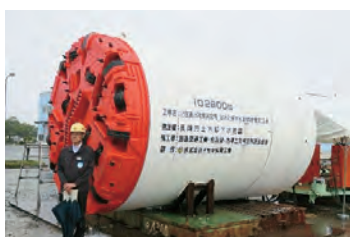
浸水対策工事(シールドマシン)
