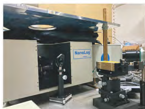
写真3 モジュール型蛍光分光測定装置
