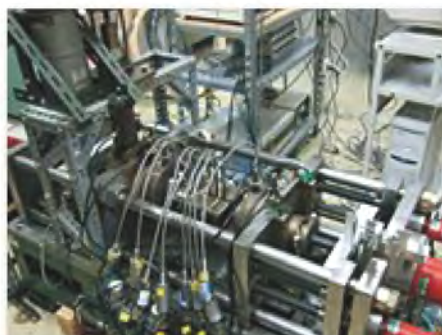
図3 背圧付加型溶融樹脂流動試験機
