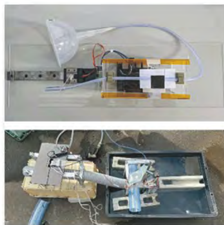
図2 稚魚選別装置の試作機
