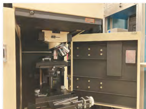
写真2 ダブルレーザー分光測定装置
