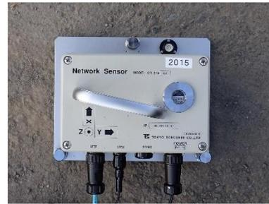
図1 微動計測機器
