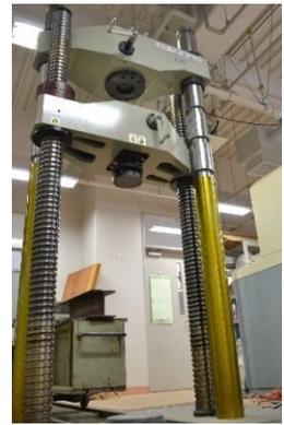
図 1 1000kN 万能試験機
