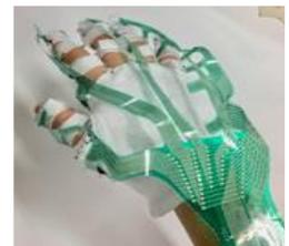
図 4 圧力分布測定
