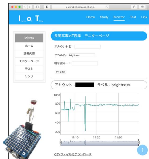
図 4: IoT リテラシー授業用のマイコンシステムとモニターページ
