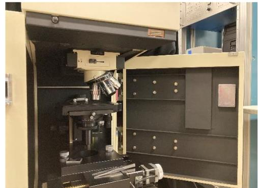
写真2 ダブルレーザー分光測定装置
