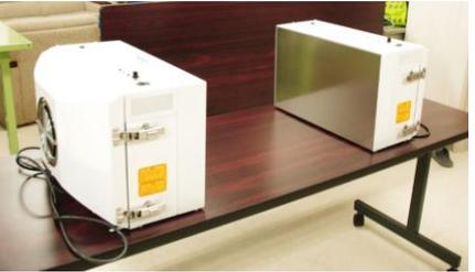
図2 オープンクリーンベンチ（清浄空間：700mm，清浄度：ISOクラス1）
