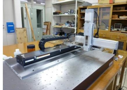
図 6 3 軸自動研磨装置 (自作機)
