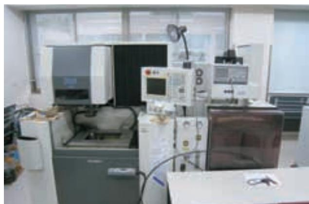
ワイヤ放電加工機 Wire Electrical Discharge Machine
