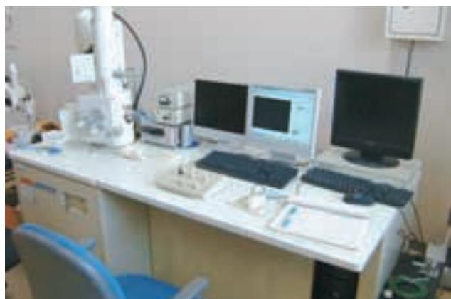
分析型走査電子顕微鏡 EDX-Scanning Electron Microscope
