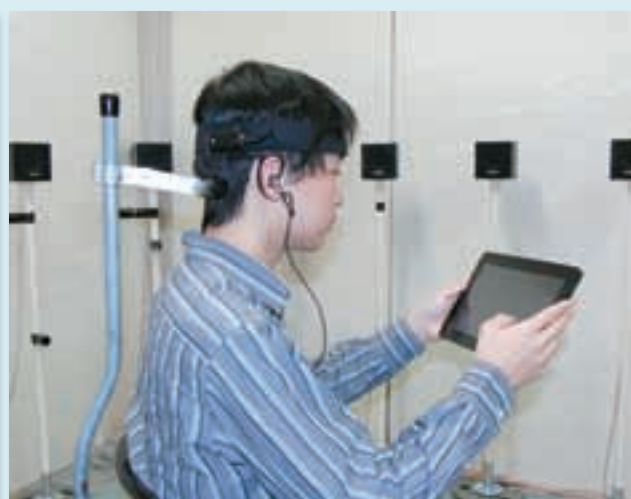
脳波センサーによる音像定位方向推定 (卒業研究) Identification of direction by brain bio-sensor using sound localization
