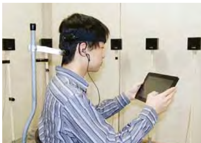
脳波センサーによる音像定位方向推定(卒業研究) Identification of direction by brain bio-sensor using sound localization
