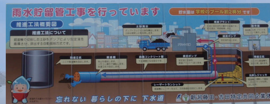
雨水貯留管工事の流れ
